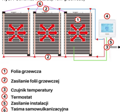
Rys.4 Schemat instalacji folii grzewczej
